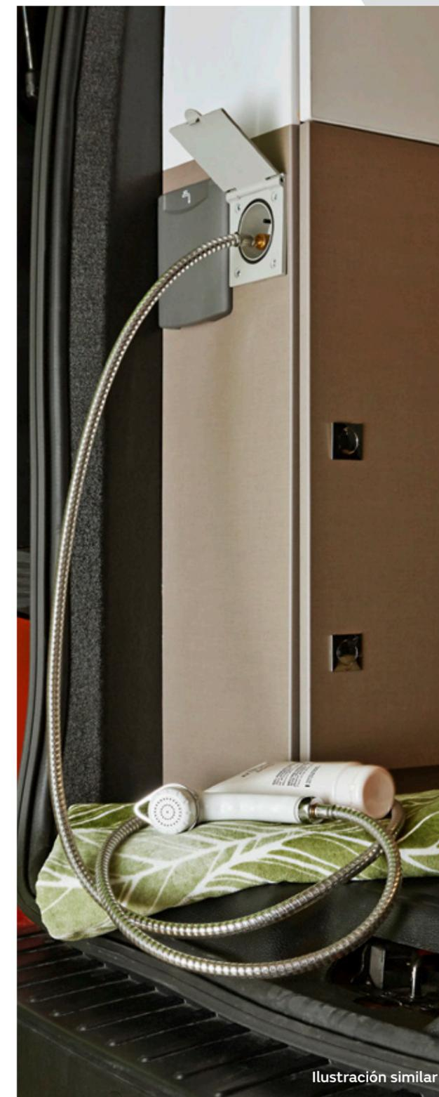
Conexión para la ducha exterior (cabezal con tubo a través de los accesorios Bürstner y de forma opcional).
